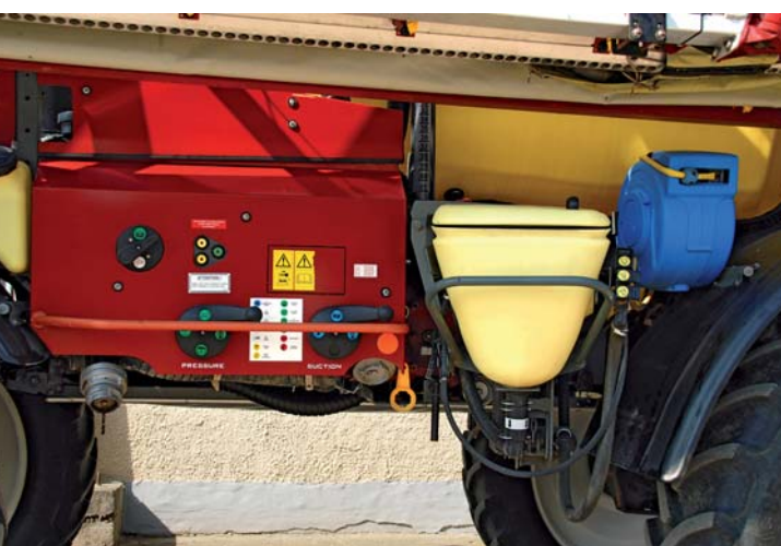
Přimíchávací zařízení na chemii s označením TurboFiller má vysokou kapacitu a poradí si s veškerou chemií i s močovinou
