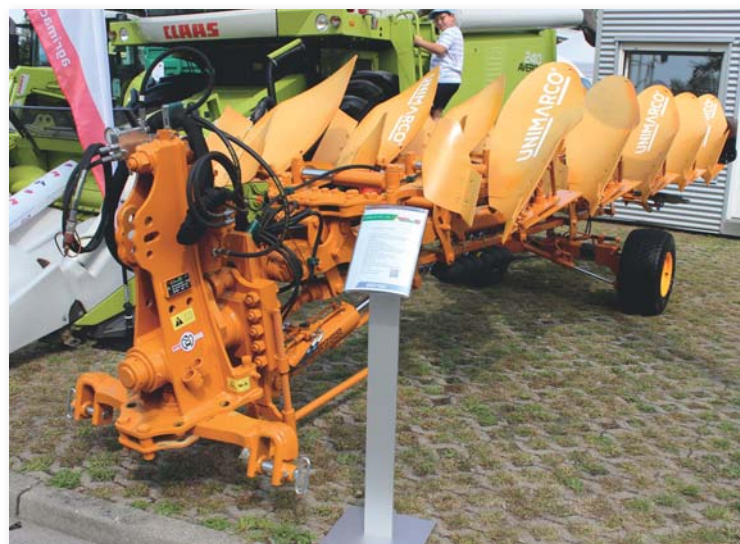
► Otočný pluh Moro Aratri Warrior PNT 14A pro orbu v brázdě v provedení radlic 4 + 1
