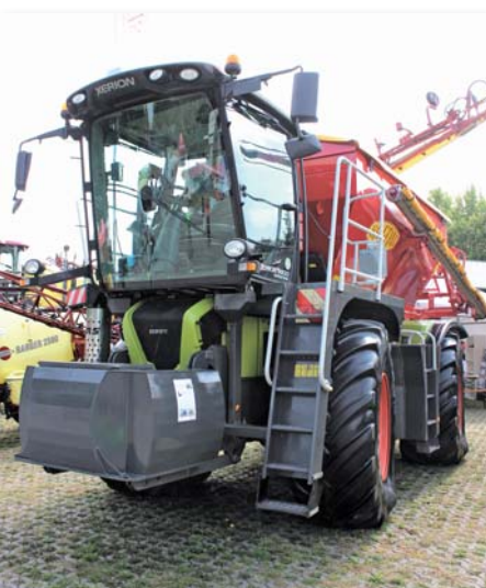
► Rozmetadlo minerálních hnojiv a vápence Bredal K105L jako nástavba na systémovém traktoru Claas Xerion v provedení Saddle Trac a s motorem o výkonu 380 k
