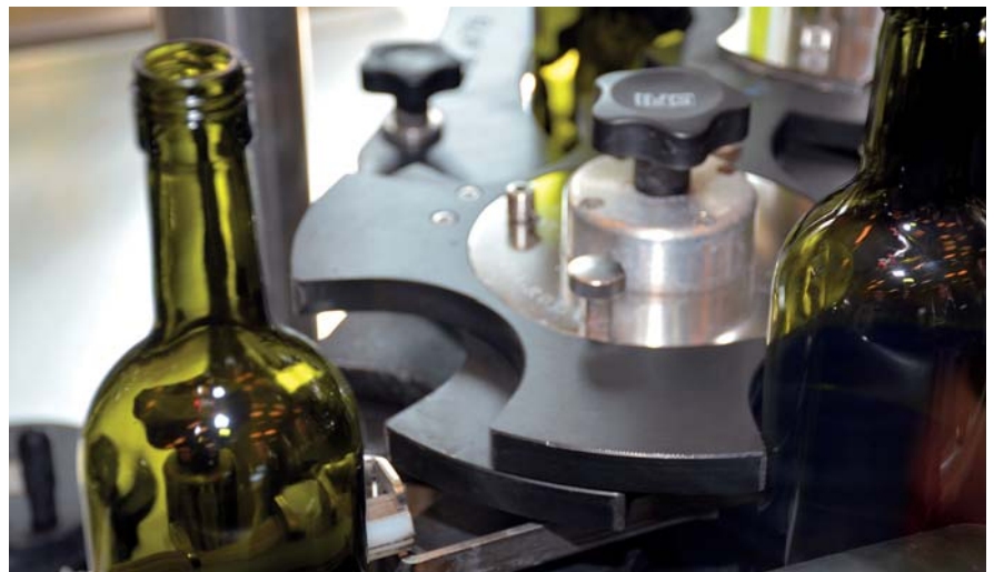
Veľkou výhodou tejto fľašovacej linky je aj nastaviteľná hviezdička na posun fliaš.
