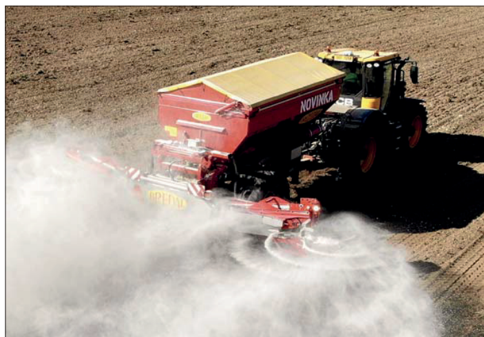
S novým rozmetadlem Bredal KX-E se dosahuje lepší kvality aplikace, především větší rovnoměrnosti a zachování dávky i v klínech díky ovládnutí sekci. S tím jde ruku v ruce i vyšší výkonnost a nižší počet jízd po poli
