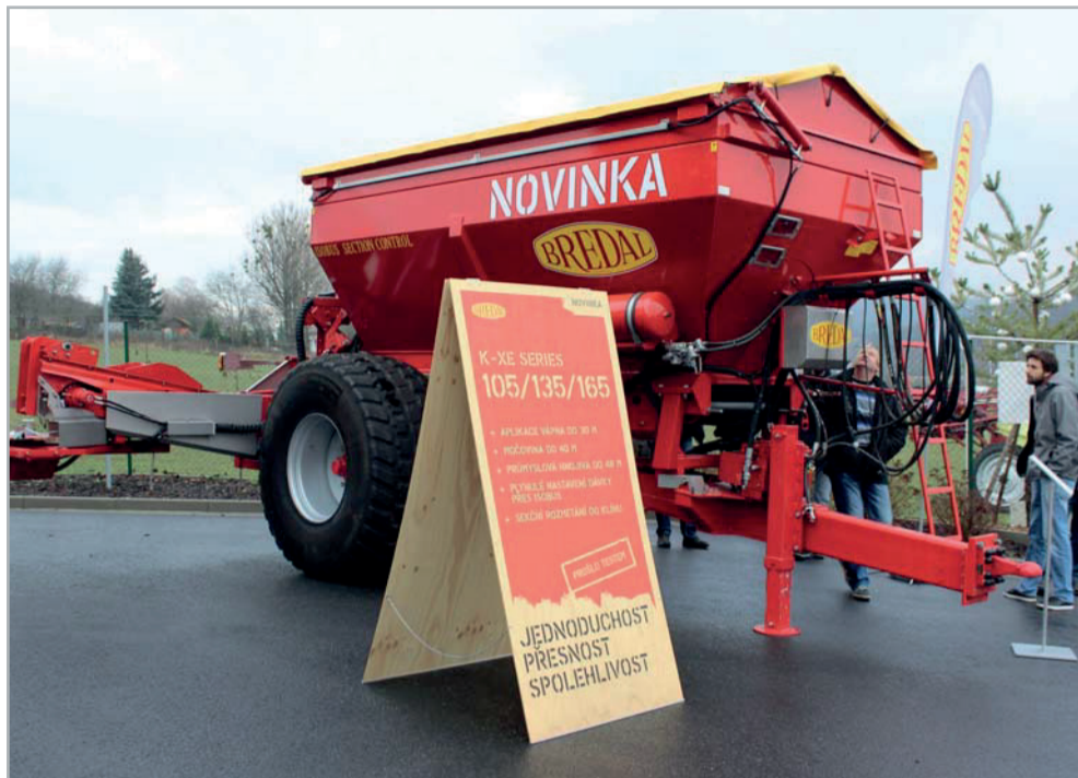
Rozmetadlo K105 XE osazené rozmetací jednotkou s rozmetacími disky vzdálenými od sebe 6 m a dvěma třímetrovými dopravníky na sklopných ramenech
