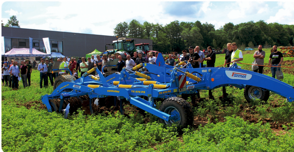
Dlátový kypřič Triolent TX 470 PS vybavený třemi řadami pružinami jištěných slupic s dláty
