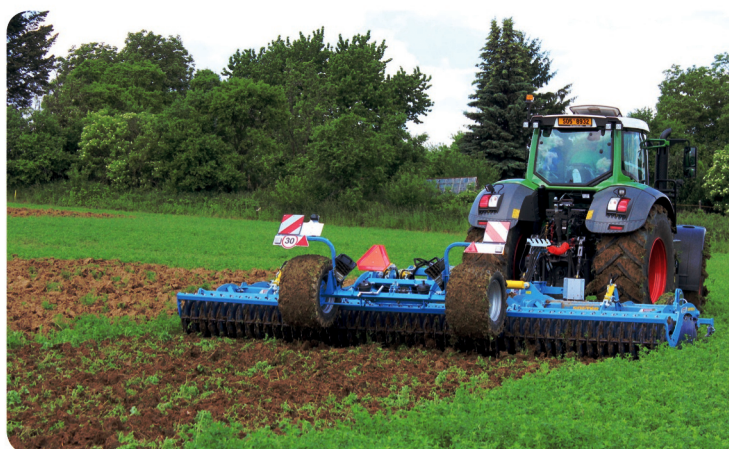
Polonesený talířový podmitač Softer 6 PS s kovanými slupicemi a talíři o průměru 560 mm
