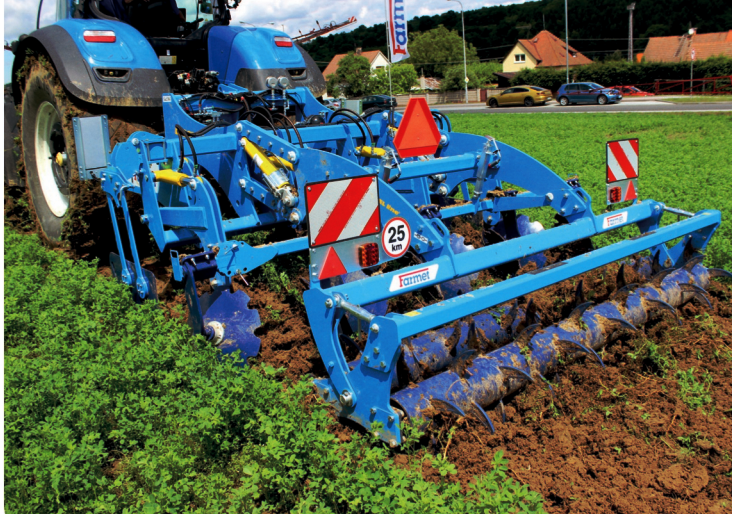
Hloubkový kypřič Digger 3 je vybaven dvěma řadami dlát pro kypření až do 50 cm
