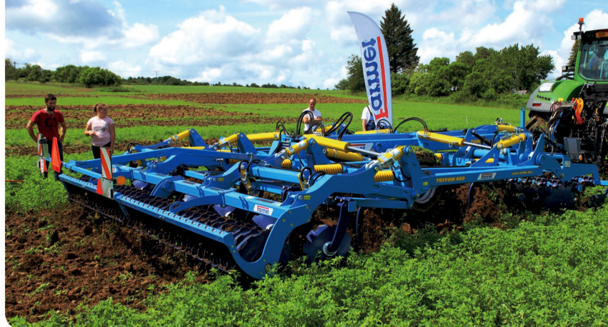
Kombinovaný kypřič Triton 450 PS s pracovním záběrem 4,5 m, vhodný do minimalizačních technologií
