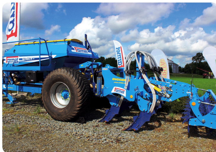
Jiné využití kypřiče Digger 3, v tomto případě v kombinaci se zásobníkovým vozem Falcon HW a soupravou pro aplikaci hnojiv
