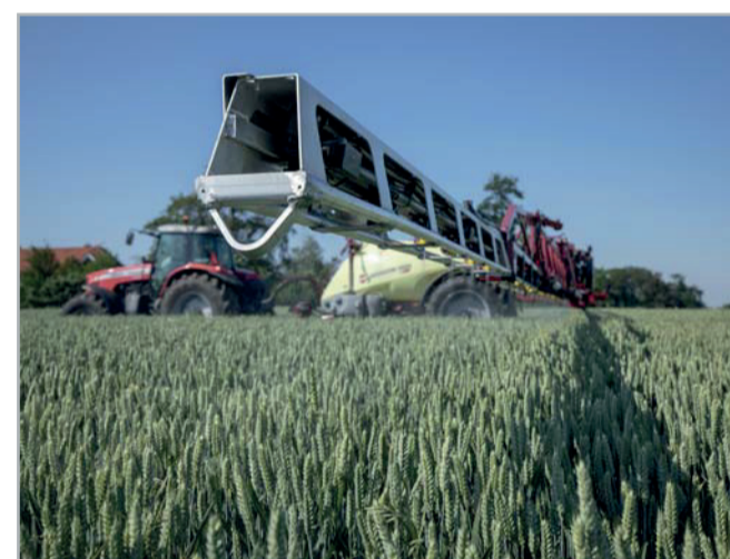
Postřikovač je vybaven regulačním systémem dávky DynamicFluid4 Foto archiv UNIMARCO
