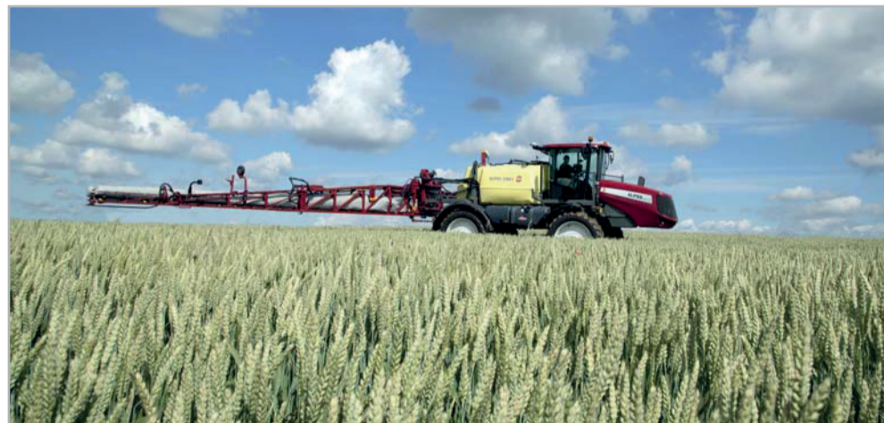
Samojízdný postřikovač Hardi ALPHA evo-i s nádrží o objemu 4100 l
