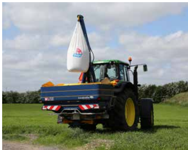
BXL 1300 unesie až 1300 kg a môže byť namontovaný na rozmetadlo s maximálnym objemom zásobníka až 3300 litrov.
