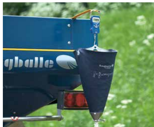
S-indikátor je jednoduchý nástroj pre kompletný test prietoku hnojiva, ktorý vykonáte v priebehu niekoľkých minút.
