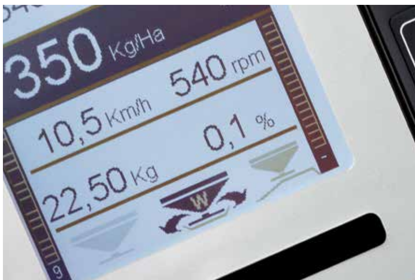
Rozmetadlá vybavené systémom váženia kalibrujú automaticky za jazdy, nie je teda nutné prietok testovať manuálne.
