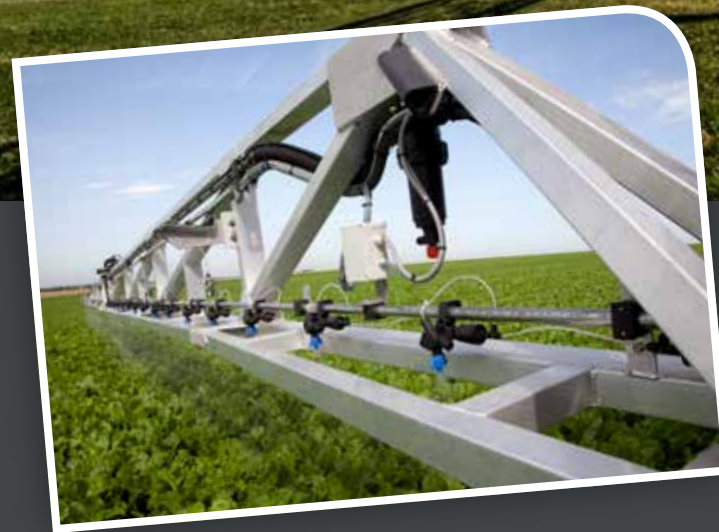
Struktura hliníkových ramen (RHA 36 - 40 m a RA 42 - 44 m)
