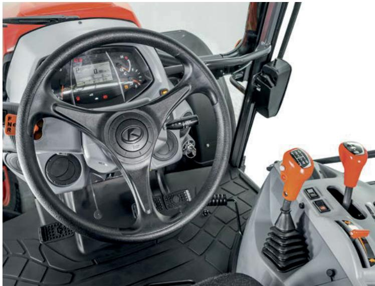
Praktický volant lze sklopit dopředu při opouštění kabiny a po návratu zpět jej můžete přesunout zpátky do výchozí polohy. Stačí pouze stisknout pedál. Kubota optimalizovala úhel sklonu volantu, který Vám dává lepší viditelnost přístrojové desky i směrem dopředu.
