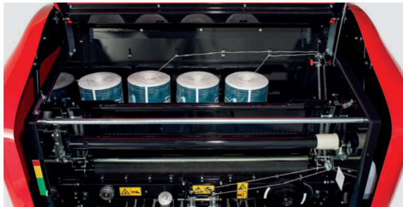
Legatore a doppio spago Double twine binding Doppelgarnbindung Układ wiązania podwójnym sznurkiem Обвязка в двойной шпагат
