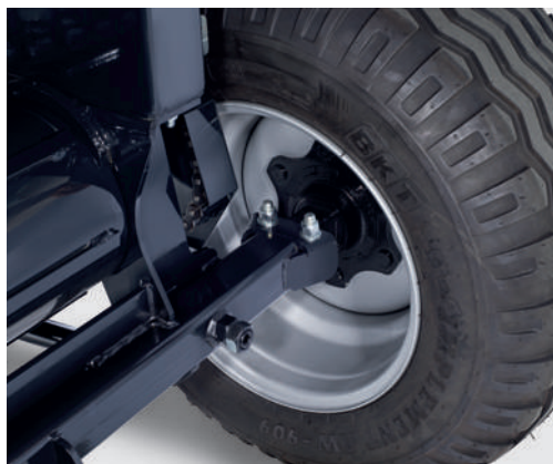
Asse ruota regolabile Adjustable wheel axle Einstellbare Achse Regulowana oś kół Регулируемая ось колеса
