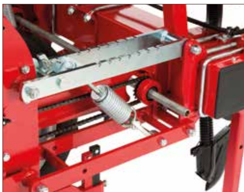
Přídavná pružina pro nastavení přítlaku na výsevní jednotku Prídavná pružina pre nastavenie prítlaku na výsevnú jednotku
