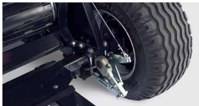
Hydraulické nebo pneumatické brzdy Hydraulické alebo pneumatické brzdy Hydraulic or pneumatic brakes Hydraulische oder Pneumatische Bremse Freni idraulici o pneumatici
