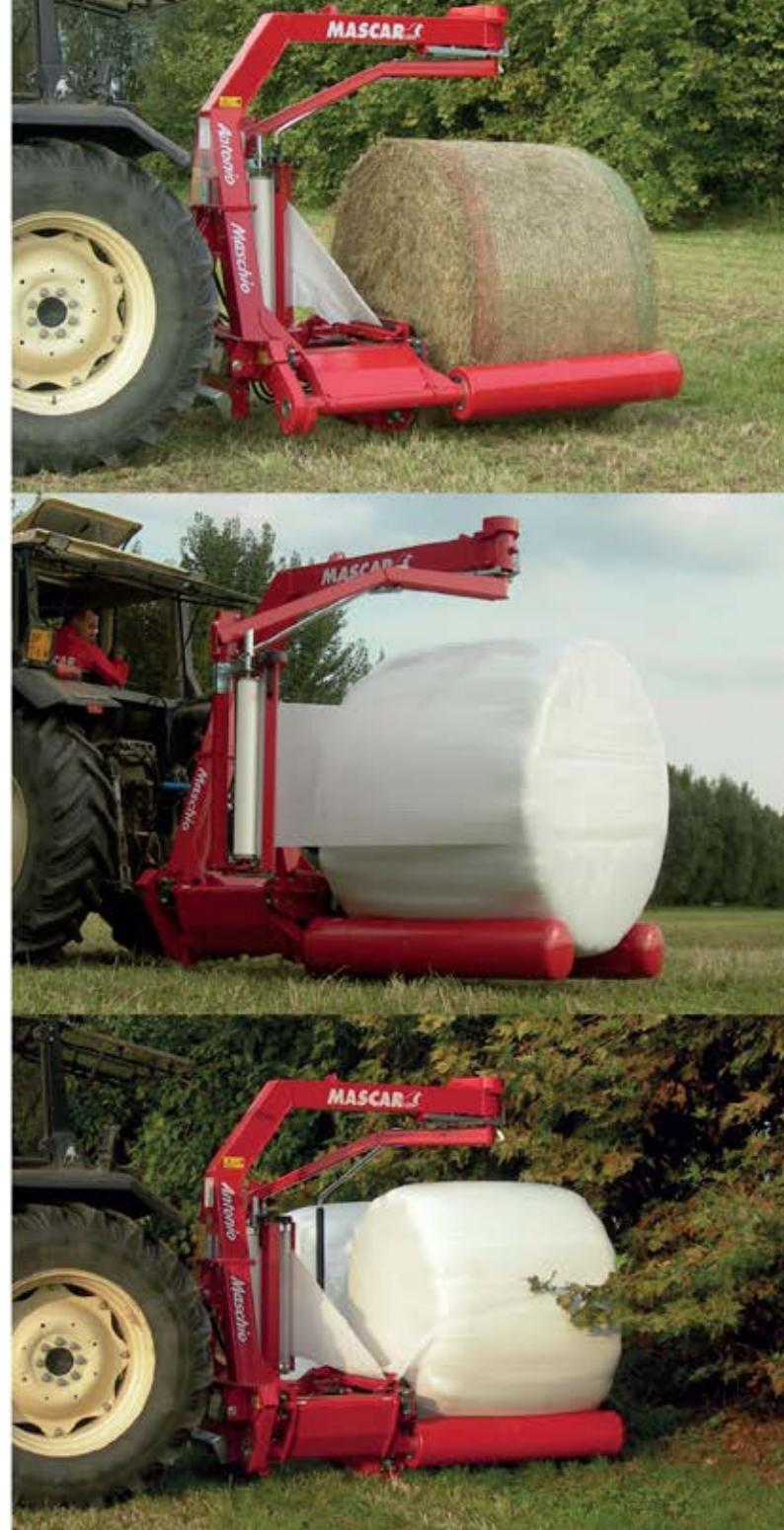
**Stála synchronizácia rýchlosťi rotácie obalovaného balíka a rotujúceho obalovacieho ramena.**
