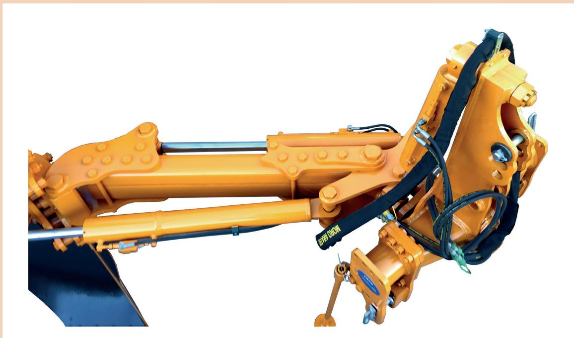
Stejným hydraulickým systémem, kterým se nastavuje pracovní záběr, je možné nastavovat pluh pro práci v brázdě nebo on-land. Druhým hydraulickým válcem se také nastavuje tažný bod.
